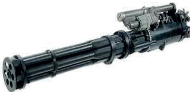
Рис. 6. Шестиствольная 23-мм авиационная пушка ГШ-6-23 (ГШ-6-23М)
