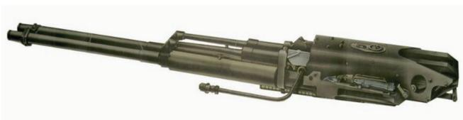
Рис. 5. Двуствольная 30-мм авиационная пушка ГШ-30 (9-А-623)
