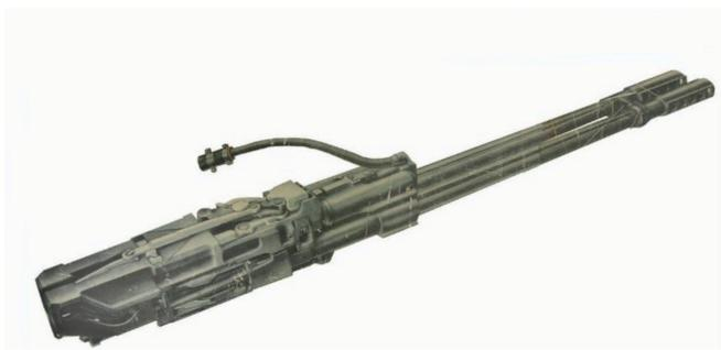
**Рис. 4.** Авиационная 23-мм пушка ГШ-23 (Грязева – Шипунова)
