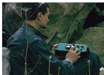
Зарядка конденсаторов БЭИ-7А и выставление частоты инициирования кассет с ДПУ-1
