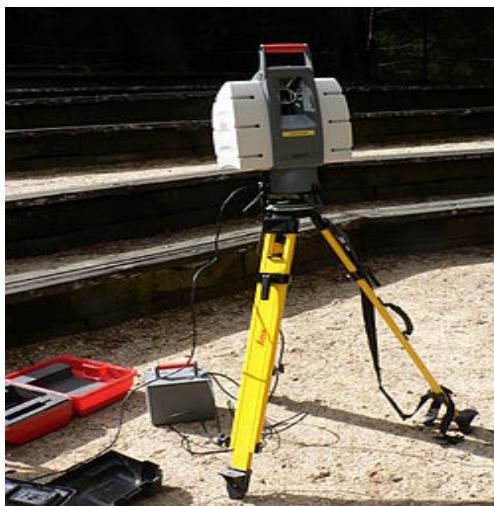
Рис. 1. Лидар, используемый для сканирования зданий и скальной местности с целью создания 3D-моделей
