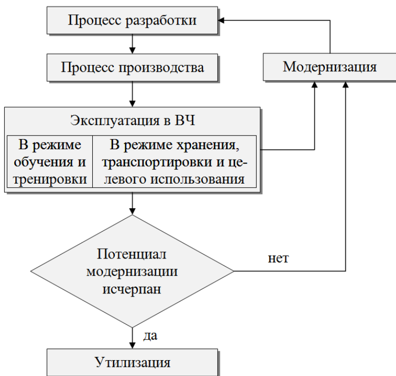
Рис. 2. Структура жизненного цикла ракетной техники
