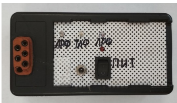
Рис. 1. Внешний вид стенда для проверки работоспособности танкового шлемофона ТШ-4М
