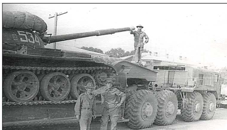
Рис. 5. МАЗ-537 с ППТ-60 при транспортировании танка Т-55
