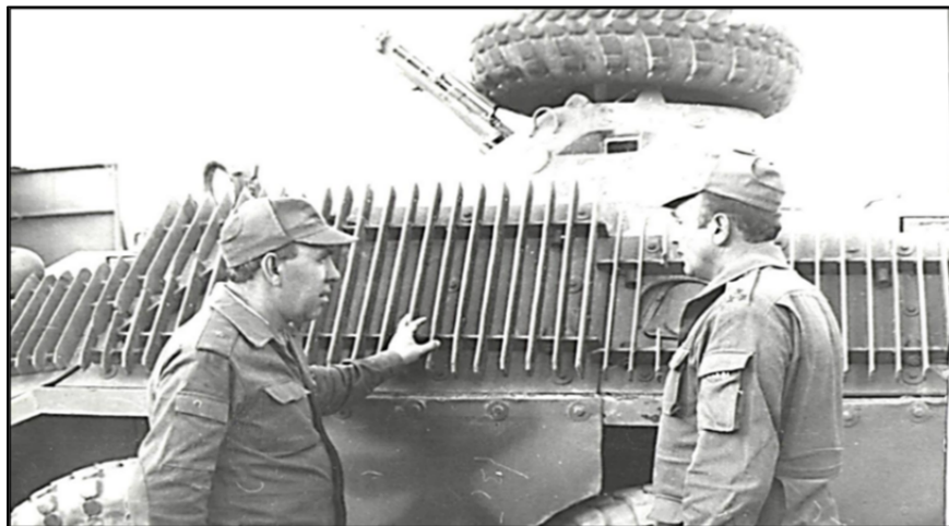
Рис. 7. Заместитель командующего 40А по вооружению генерал-майор Маев С.А. знакомится с противокумулятивной решеткой на БТР
